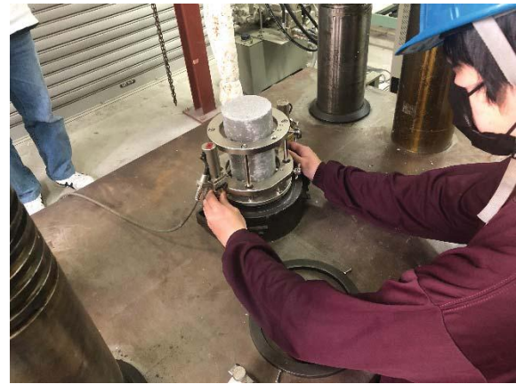
コンクリートの圧縮強度試験
