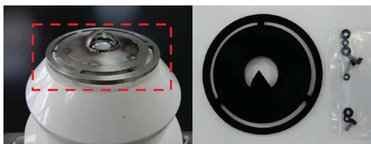
写真 放射計遮蔽板(左：塗装前. 右：塗装後)
