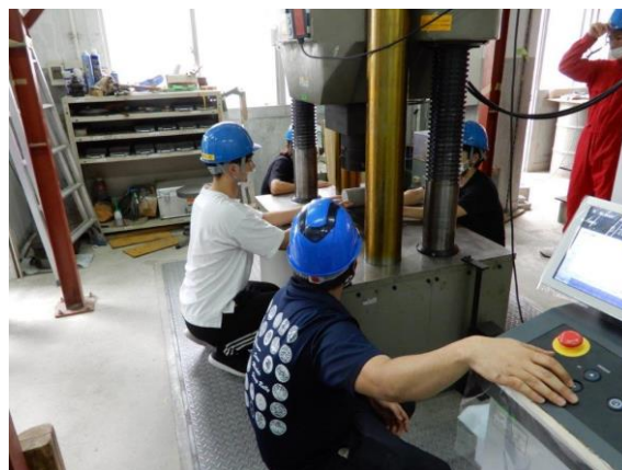
コンクリートの強度試験実施(学生実験)
