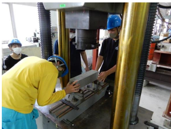
コンクリートの強度試験実施(学生実験)
