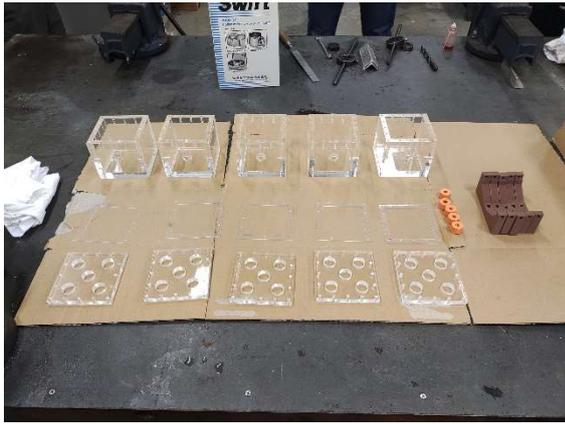
腐食試験用アクリルセル
