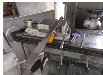
疲労試験片の切削加工
