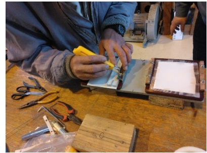
電熱面張り替え修理
