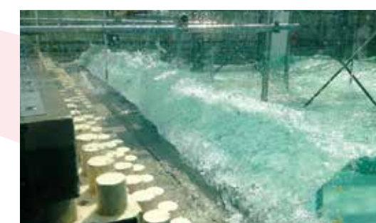
大型水槽を用いた消波ブロック開発
