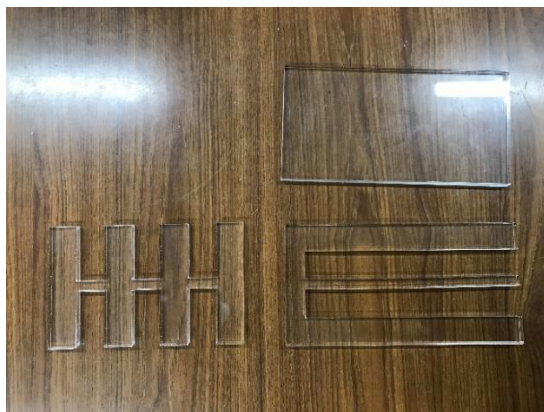
攪拌羽根及びロータリーエンコーダ用スリット円盤の製作 (レーザーカッターによるアクリル材の切り出し)
