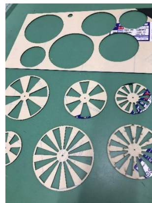
攪拌羽根及びロータリーエンコーダ用スリット円盤の製作 (レーザーカッターによるアクリル材の切り出し)
