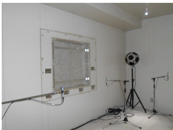
金属屋根遮音性能試験残教室測定状況写真
