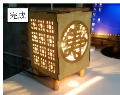
ランプシェードの製作 (レーザーカッター及び CNC フライス加工)
