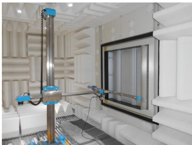
金属屋根遮音性能試験無響室測定状況写真
