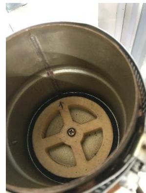
排気管内部品 (3D プリンタによる製作)
