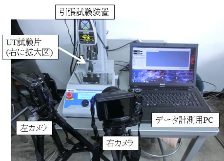
(a) 2台のカメラを用いた ゴムの引張試験
