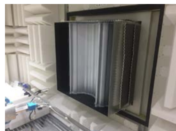
三層折板屋根材料遮音試験
