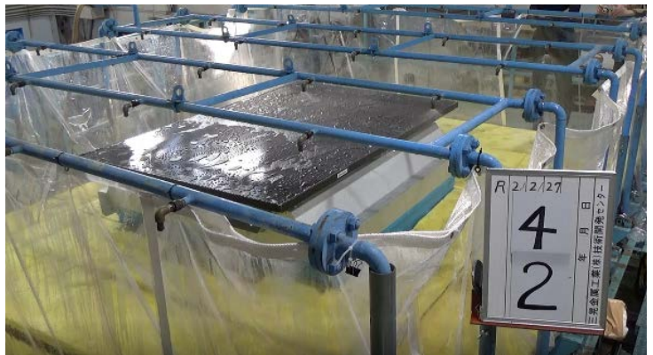
金属屋根散水試験の様子
