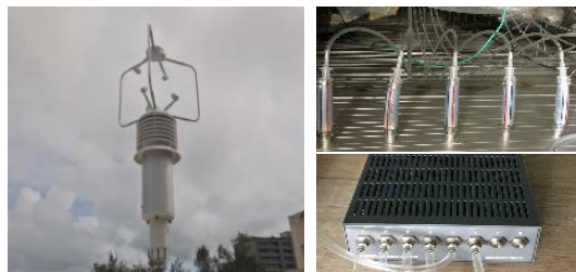
3次元超音波風向風速計
