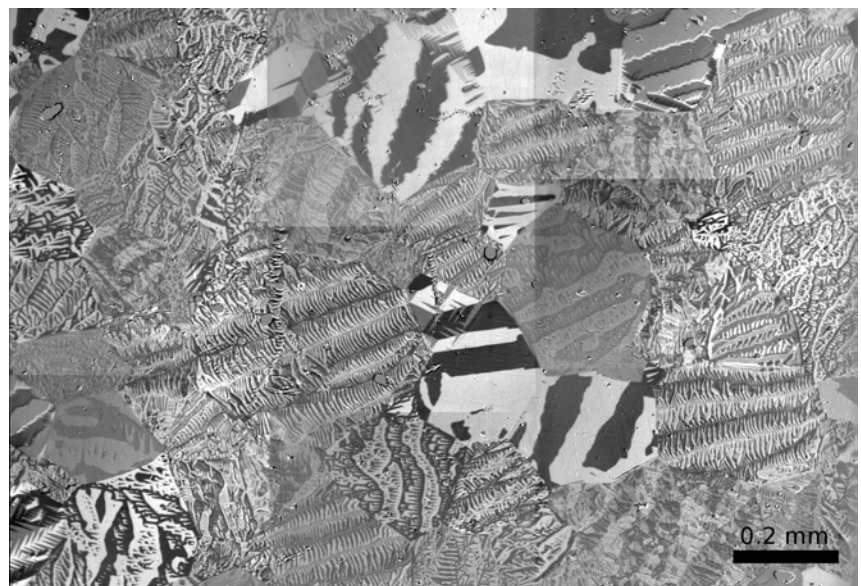
図1 無方向性電磁鋼板の広範囲高倍率磁区観察例
