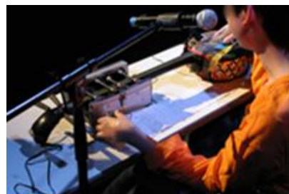
図1 押弦操作を支援する装置を市販のサンシンに取り付けた様子。左手の手のひらに本装置を操作するコントローラが置かれている。
