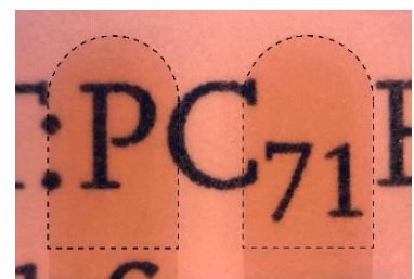
図 3 MoO 3 / Mg / Au 陰極を用いる半透明 OPV の写真 (発電部分を破線で示しています)。
