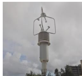
3次元超音波風向風速計
