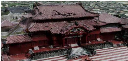
写真測量により作成した3Dモデルの表示
