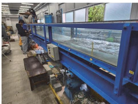
実験水路 (跳水の実験)
