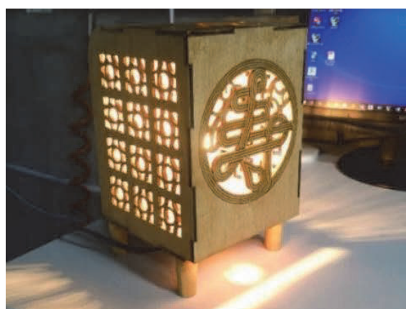
ランプシェード(CNC フライス盤、レーザー)
