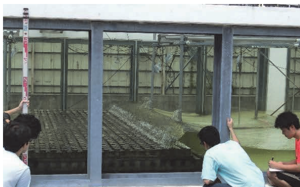
日本の大学としては最大規模の造波水槽 (人工リーフによる波の消波効果に関する実験)
