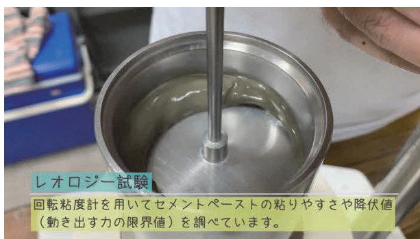
円筒回転粘度計によるレオロジー試験
