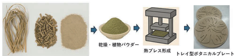
植物を使ってボタニカルコンクリート（プレート）製作体験 しまジオポリマーコンクリート製品
