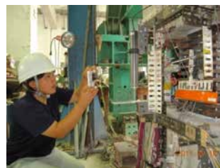
鉄筋コンクリート柱の耐震補強実験
