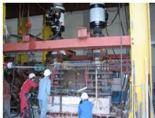
RC造建築物の耐震実験
