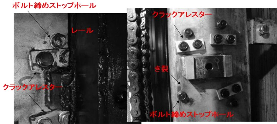
設備で発生したき裂が停止した状況：継続稼働が可能になり設備停止の損失が防げた
