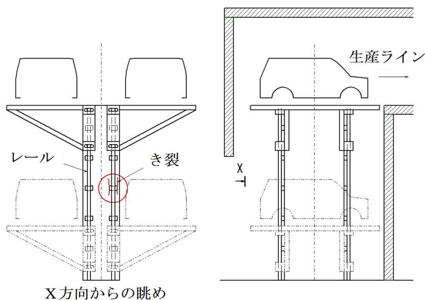
一階で塗装し、2階で乾燥焼きつけ：き裂は車昇降用の支柱で多数発生
