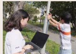
▲構造物の振動特性の現地調査
